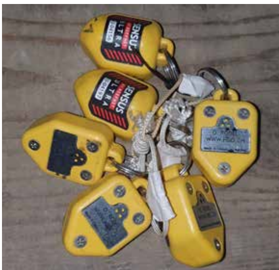
Figure 1 : Les capteurs commandés par Olivier et gravés à son nom, ils ont enregistré les pressions et températures dans la Bouna entre 2008 et 2012.
